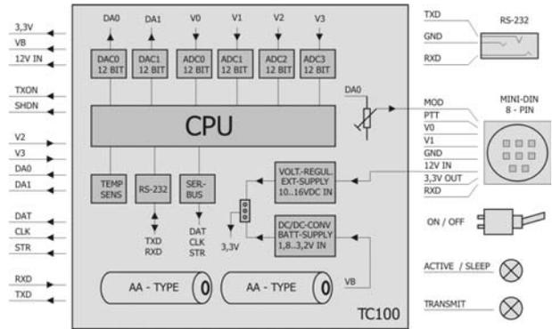
Der TC100 wurde als universelle Mess- und Steuereinheit speziell für drahtlosen Einsatz entwickelt. Durch Laden eines geeigneten Userprogramms wird er schnell zum Controller für APRS Betrieb. Folgende Möglichkeiten stehen dabei zur Auswahl:
